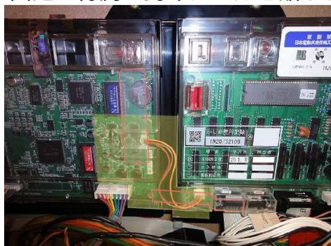
**特長** 通信ケーブルの交換・継ぎ足し等されないようカバーで防護し封印シールで管理します
