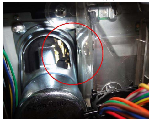
被害台のスピーカー損傷部分
