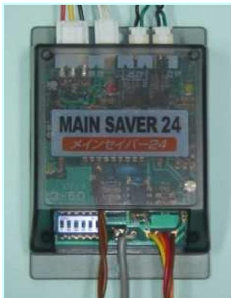
「メインセイバー-24」はスロット台の主基板に何らかの接触があった事をいち早く検出しホールスタッフへお知らせする装置です。これにより今般、多数報告されている基板ケースくり貫きや壁破り等の手口による不正基板の混入も検出します。また「メインセイバー-24」は夜間モードを搭載しており、翌朝の営業前に検知の有無をお知らせする事も可能です。
