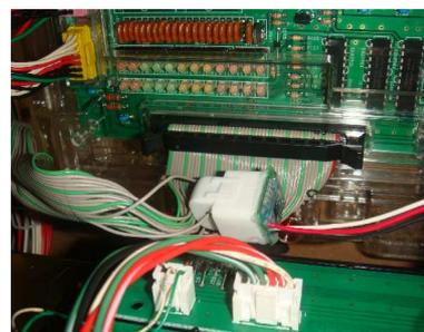
付属の電流センサー取付け
